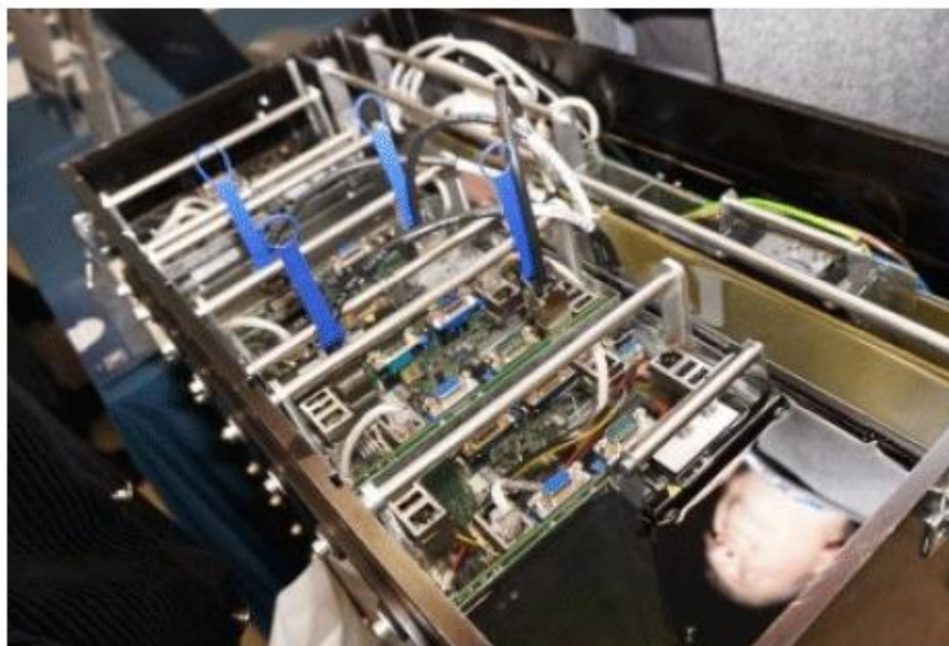
В решениях Immers вычислительные компоненты полностью погружены в диэлектрическое масло
