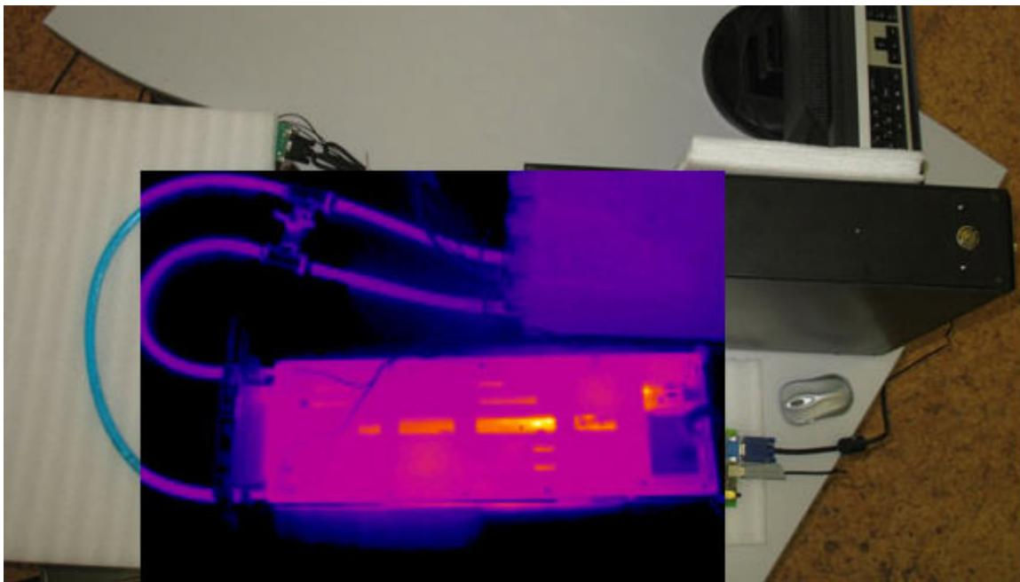
В результате работы созданного технологического решения было установлено, что максимальная температура жидкости на выходе из теплообменного контура вычислителя составляет 55 градусов Цельсия (в отличие от стандартных 20-23 градусов), при этом наблюдалась устойчивая работа всей системы на базе 6-ядерных процессоров Intel Xeon серии 5600 в пределах допустимых температурных режимов.
