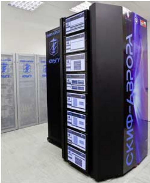
Разработчики заявляют, что "СКИФ-Аврора ЮУрГУ" - первый в мире суперкомпьютер на базе современных процессоров Intel Xeon и жидкостного охлаждения на уровне плат
