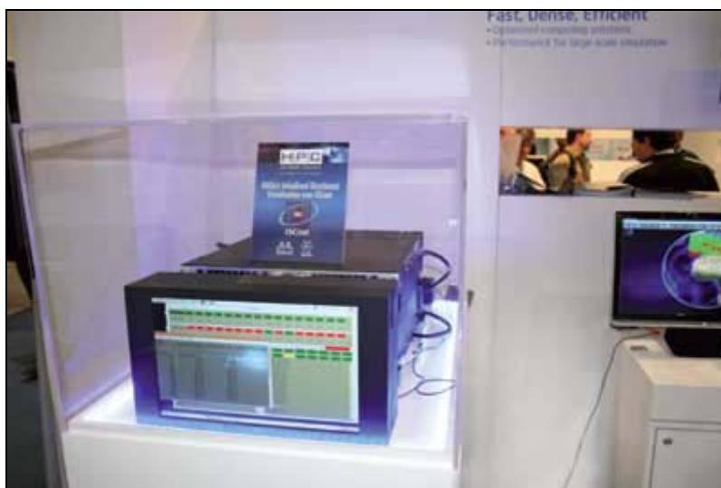
Работающее шасси вычислительного модуля «СКИФ Аврора» (слева), считается реальная задача предсказания глобальной погоды с выводом результата на внешний монитор (справа)
