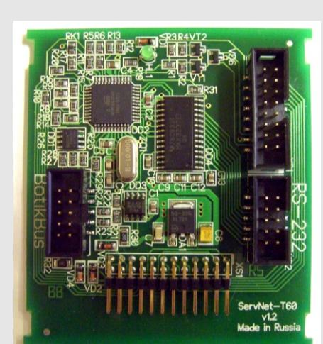
ServNet-T60: плата управления вычислительным узлом-лэзвием, 80x70 мм
