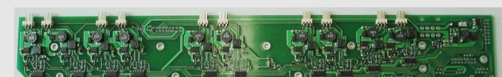
ServNet CMB: плата управления вентиляторами шасси, 372x60 мм
