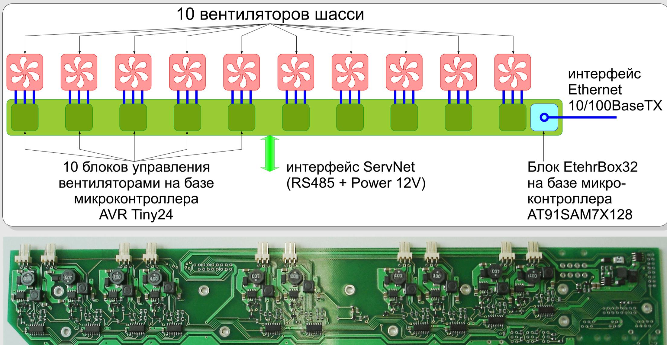
ServNet CMB: плата управления вентиляторами шасси, 372×60 мм.
