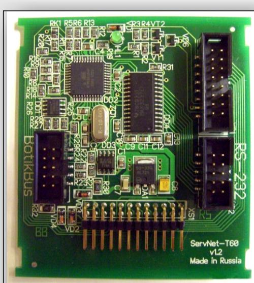
ServNet-T60: плата управления вычислительным узлом-лезвием, 80×70 мм
