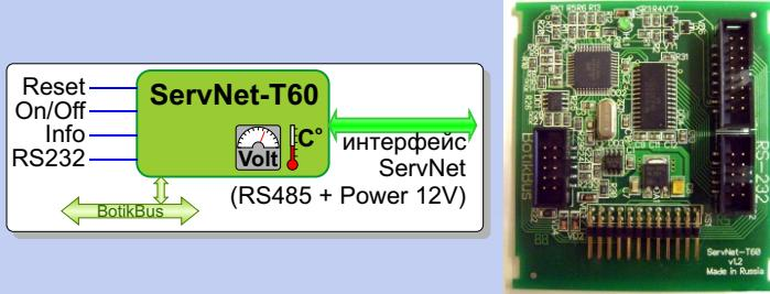
Рис. 2. ServNet-T60: плата управления вычислительным узлом-лезвием, 80×70 мм
