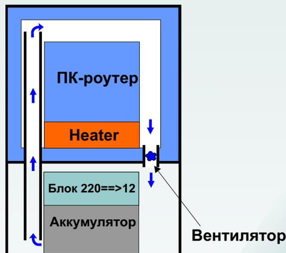
Контейнер состоит из двух секций: термоизолированной, где расположено оборудование, и термонеизолированной, где располагается аккумулятор и блок питания. При этом при температурах от минус 10 до плюс 25 градусов, которые характерны для средней полосы России, не требуется включение ни обогревателя, ни вентилятора.
