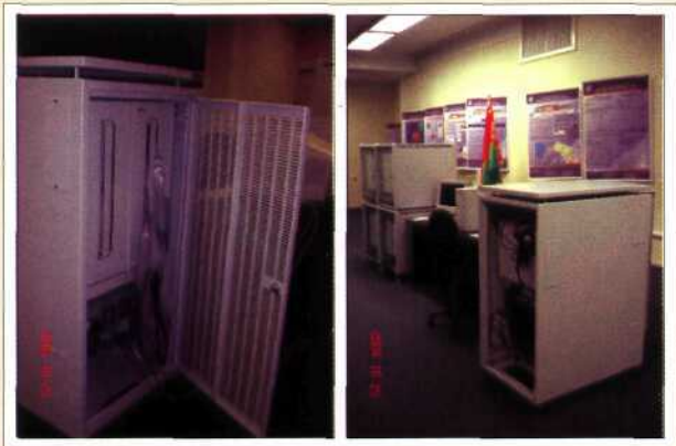
Рис. 3. Базовый вычислительный модуль ОВС, подключенный к кластеру «Первенец-М» (Переяславль-Залесский, ИПС РАН, осень 2004 г.)
