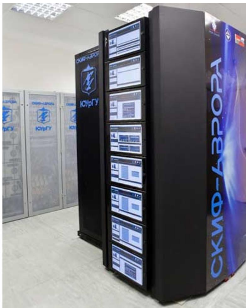
*Технические характеристики суперкомпьютера «СКИФ-Аврора ЮУрГУ» (вычислитель системы содержит 256 компактных и мощных вычислительных blade-модулей с жидкостным охлаждением):*
