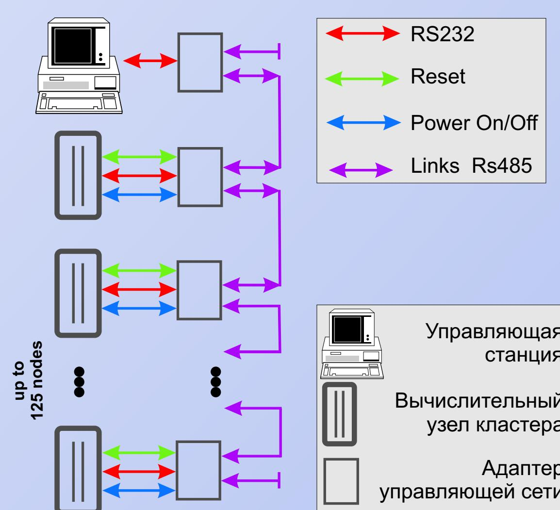
Рис. 2. Структурная схема управляющей сети кластера
