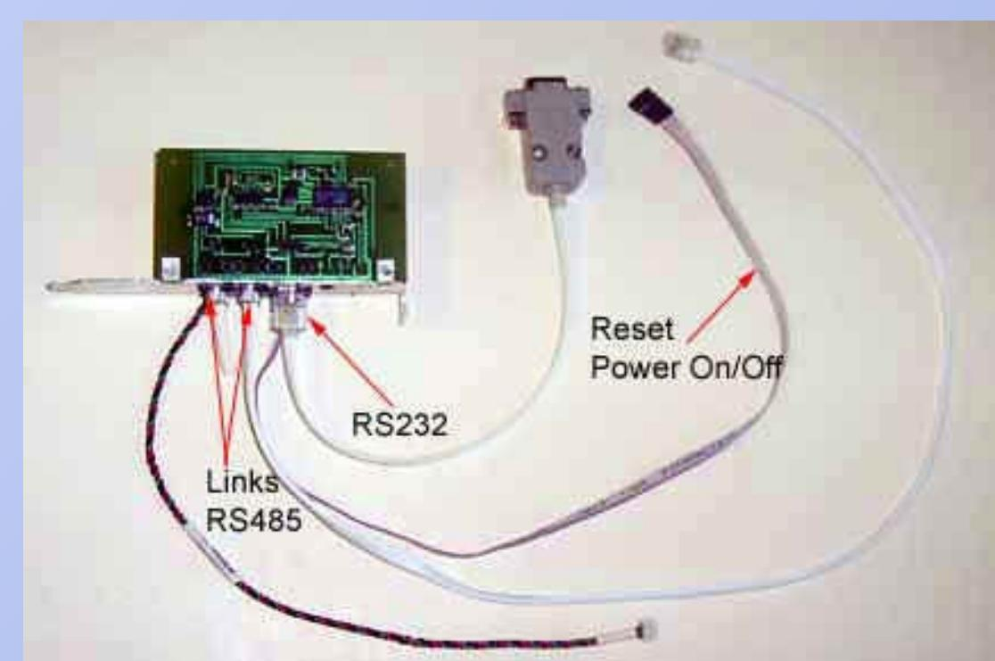
Рис. 3. Схема подключения кабелей на плате
