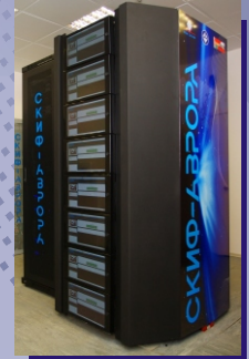
Слева: модуль и шкаф “СКИФ-Аврора” 4/Н (24 Tflops на шкафу). В центре: “СКИФ-Аврора” 4/В (40 Tflops на шкафу). Справа: “СКИФ-Аврора ЮУрГУ”.
